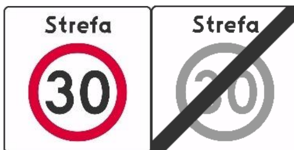
Rys. 5.3.3.1. Znaki B-120, B-121 stosowane w strefie wjazdowej i wyjazdowej z MOP.
