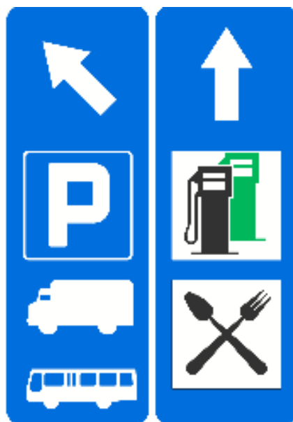
Rys. 5.3.3.5. Przykład rozwiązywania tablicy D-217 w układzie pionowym
